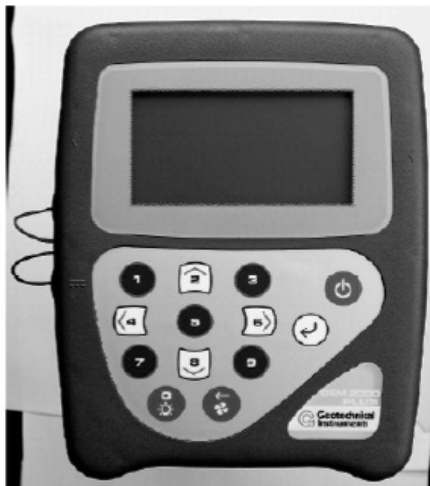
Slika 3.2 : Multi gasni detektor „Geotechnical Instruments - GEM2000plus“
