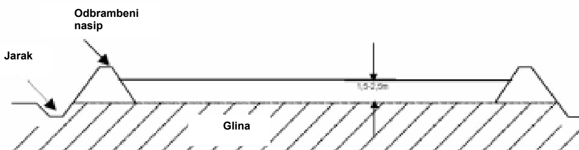
Slika 6-15: CDF objekat na prirodno glinovitom sloju (bez obloge)
