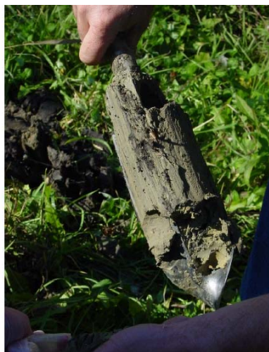
Slika 4-5: Uzorkovanje zemljišta uz pomoć Edelman ručne bušilice
