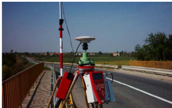
Slika 6-11: GPS suvozemna stanica za kalibriranje
