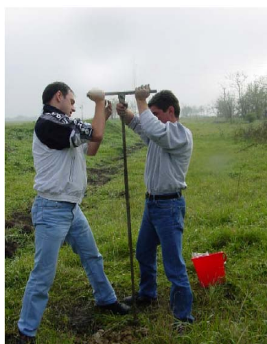
Slika 4-5: Uzorkovanje zemljišta uz pomoć Edelman ručne bušilice
