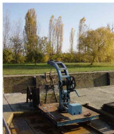
Slika 3-10: Dizalica za postavljanje ploča
