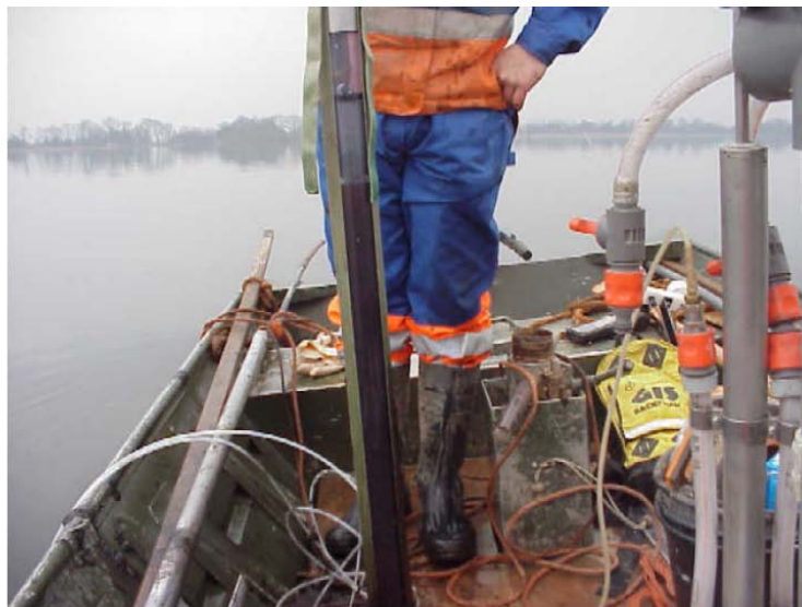
Slika 4-4: Uzimanje uzoraka iz Kanala uz pomoć Eijkelkamp Core Sampler-a (Beeker Sampler)
