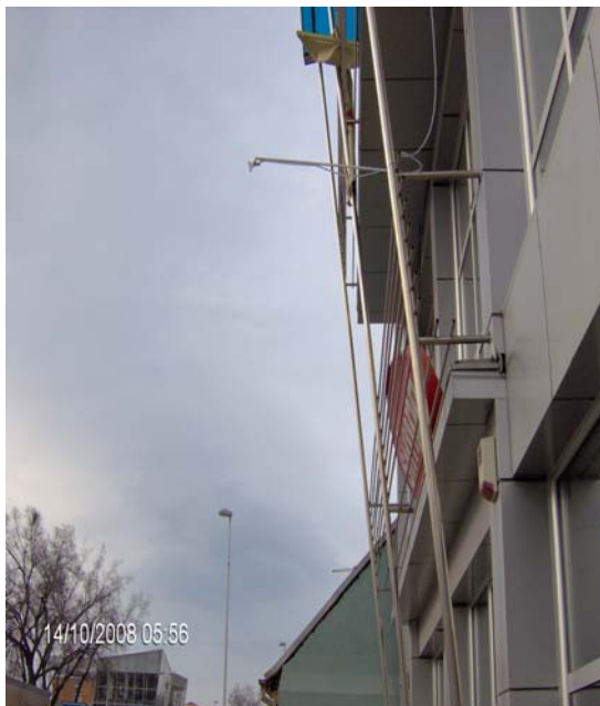
Slika b) Merno mesto za uzorkovanje sumpordioksida, čađi, azotnih oksida i prizemnog ozona u Partizanskoj ulici u Novom Sadu
