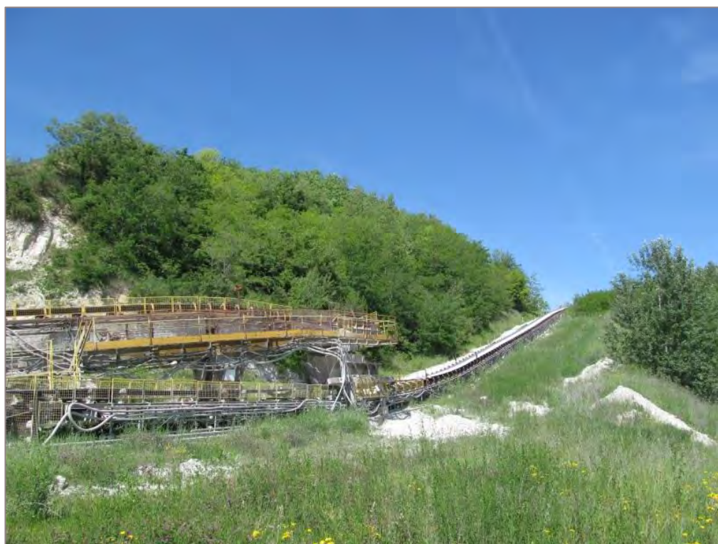
Сл. 4. Покретна трака за транспорт сировине на копу Филијала
