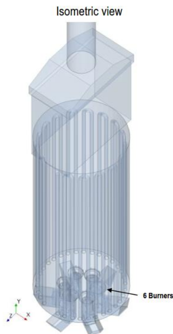
Slika 3.2.2. Prikaz položaja 6 gorionika (6 burners) u peći BA-2301
