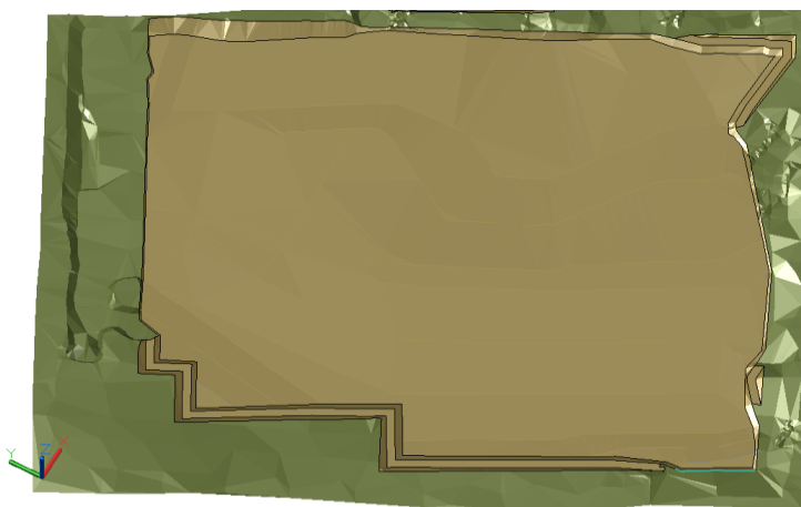
Слика бр.22: Дигитални 3D модел укупног откопа након X године експлоатације – полигон 1
