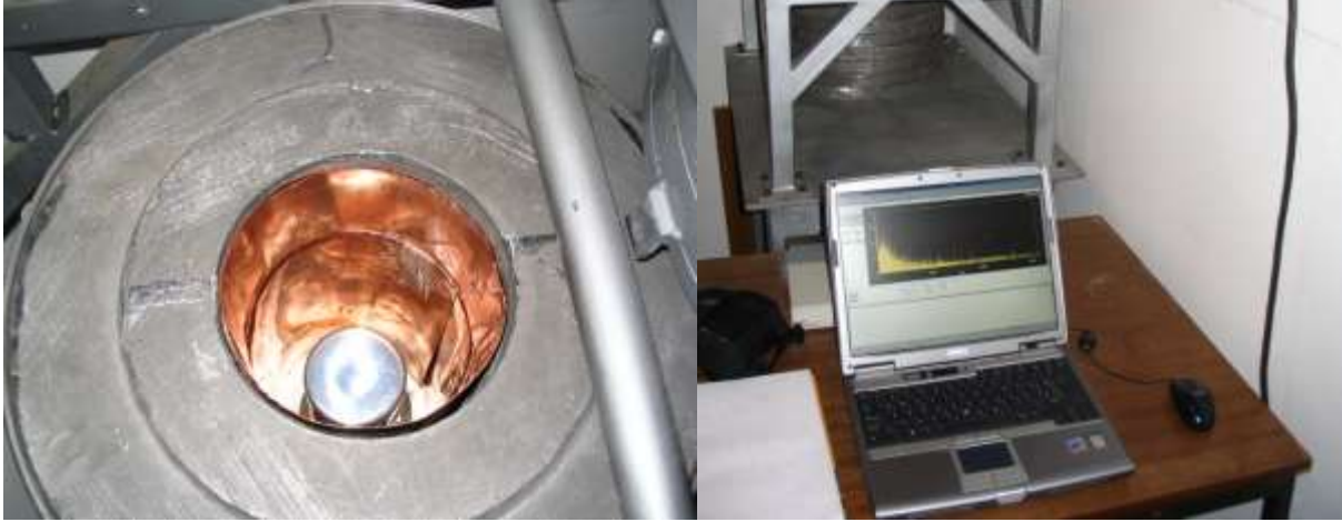
Slika 6. HPGe spektrometar proizvođača Canberra u niskofonskoj zaštiti od olova
