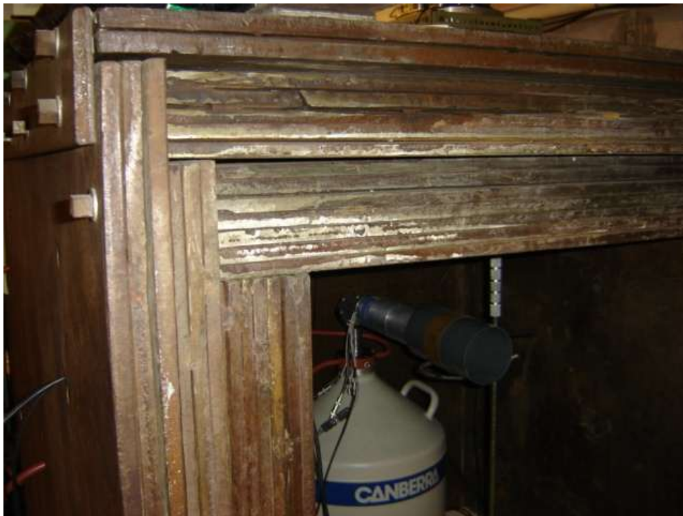
Slika 5. HPGe spektrometar proizvođača Canberra u niskofonskoj zaštiti od gvožđa
