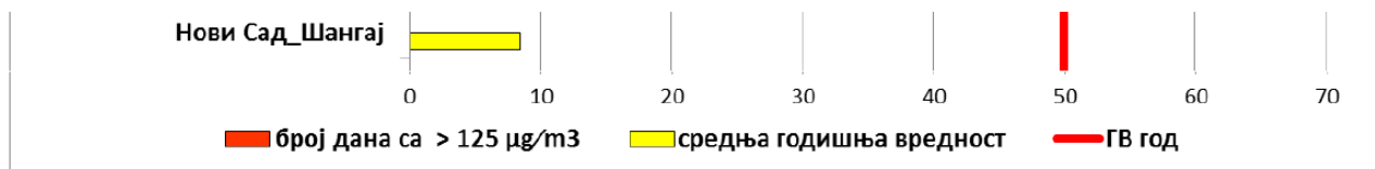
Slika 5.3.1: Uporedni prikaz srednje godišnje koncentracije SO 2 (µg/m 3 ) i broja dana sa prekoračenjem GV u 2018.godini po podacima iz državne mreže (referentna metoda merenja) za aglomeraciju Novi Sad, merno mesto Šangaj (L)
