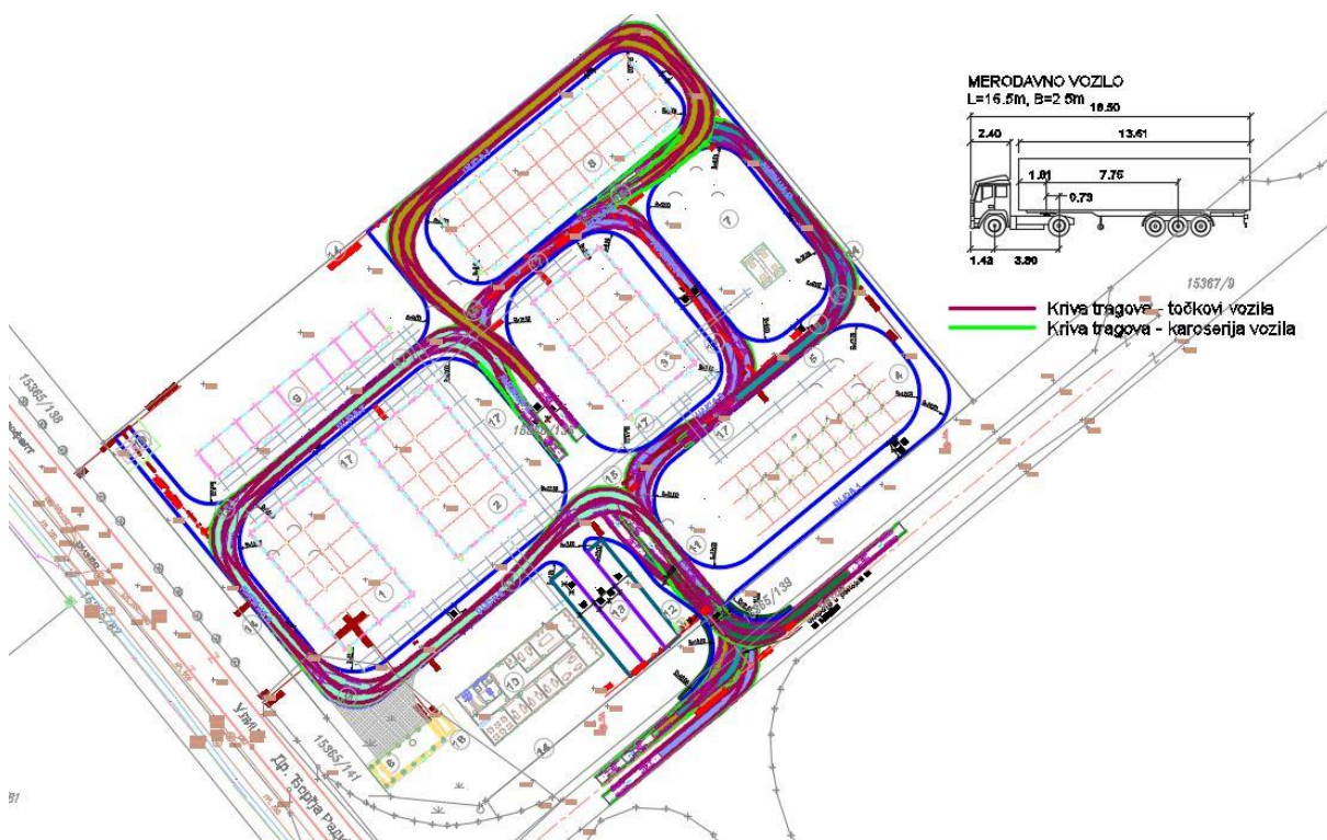
Слика бр. 1- Приказ кретања меродавног возила (криве трагова точкова и каросерије возила)
