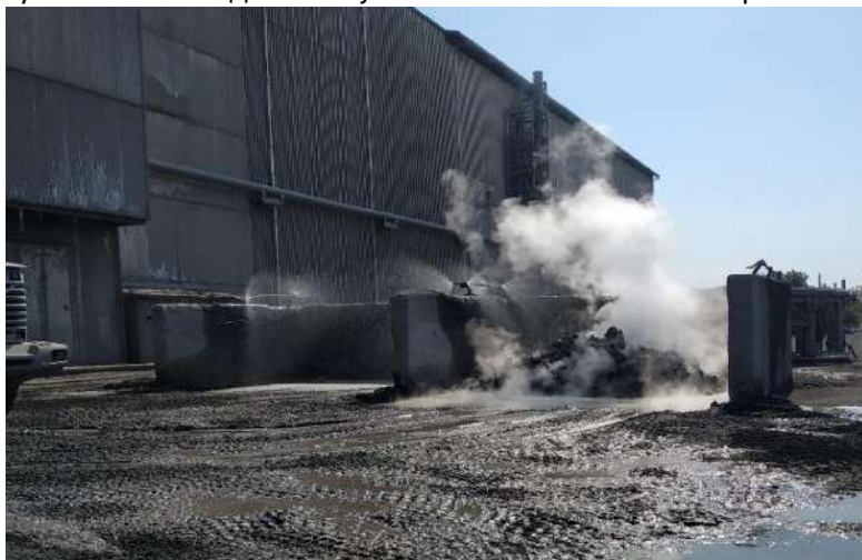
Слика 8 – Хлађење шљаке у боксовима за хлађење
