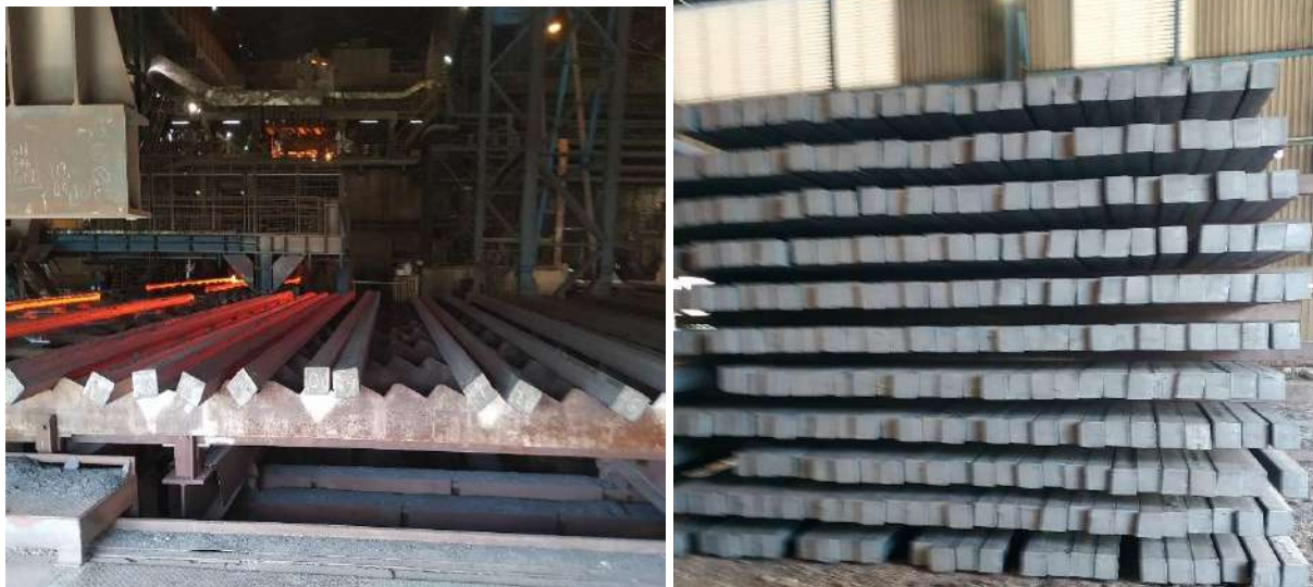
Слика 6 – Сто за хлађење челичних гредица и њихово складиштење
