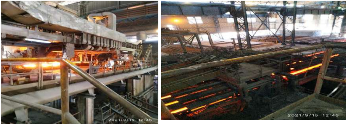
Слика 5 – Машина за континуално ливење и калупи
