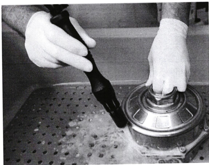
Slika: Pranje zauljenih delova u bio circle uređaju
