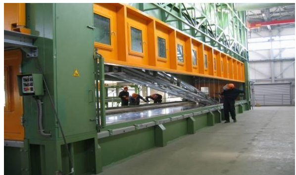
Слика 8 - Комора са кадом са растопљеним цинком (позиција за урањање и израњање конструкци)
