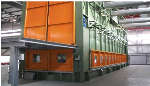
Слика 7- Комора са кадом са растопљеним цинком (позиција у току потапања елемената)
