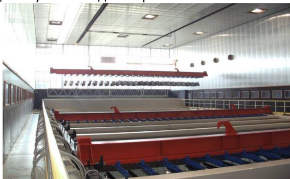
Слика 5 - Изглед коморе са купкама за декапирање
