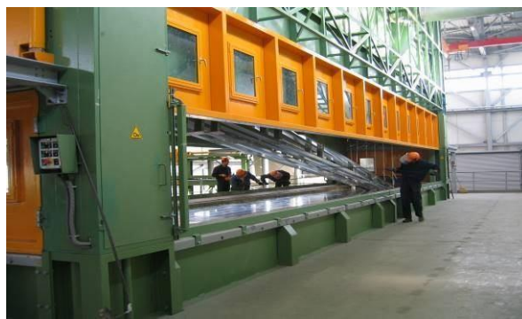
Слика 8 - Комора са кадом са растопљеним цинком (позиција за урањање и извађање конструкције)
