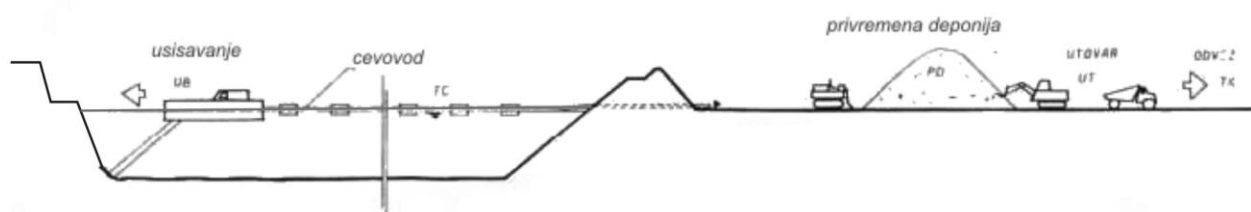
Slika 1. Tehnološka šema otkopavanja i utovara peska.
