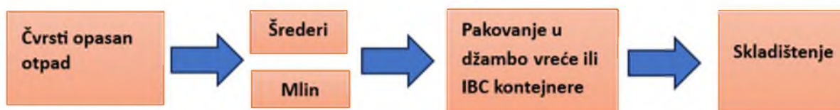
Slika 21. Blok šema fizičkog tretmana čvrstog opasnog otpada
