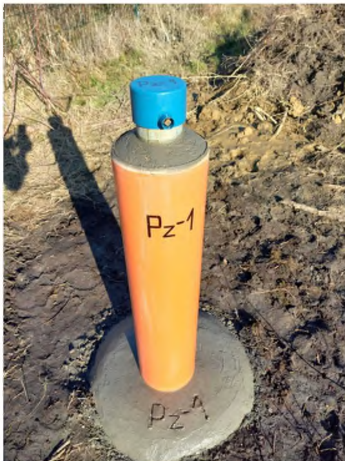
Slika 27. Izgled pijezometra za osmatranje nivoa i kvaliteta podzemnih voda
