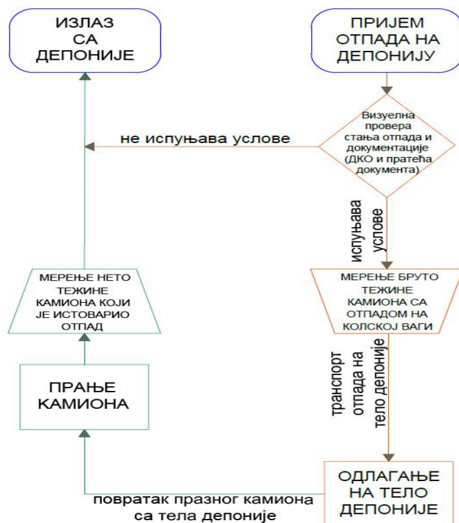
Слика 5: Шематски приказ технолошког поступка одлагања отпада на депонији FCC Kikinda doo у Кикинди
