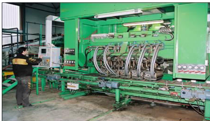
Slika 4. Petoglava presa sa gipsanim kalupima, proizvođača Rieter
