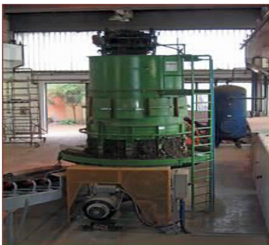
Slika 6. Kružni homogenizator, proizvođača Rieter
